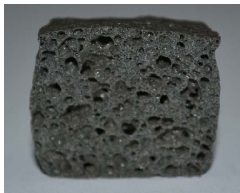
Образцы пеношлакостекла, полученные по скорректированному режиму термообработки
