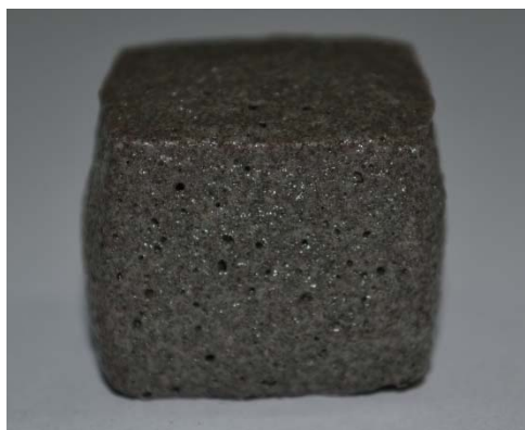
Образцы пеношлакостекла, полученные по скорректированному режиму термообработки
